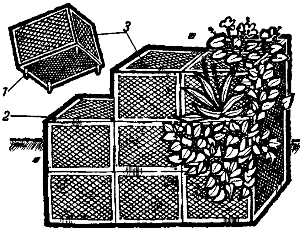
Рис. 8. Цветочная стена из отдельных элементов: 1 — шипы; 2 — пазы; 3 — одинаковые «строительные эле- менты».
